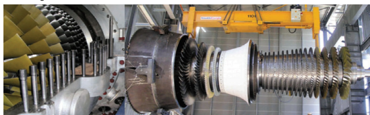
Turbina a gas ciclo combinato
