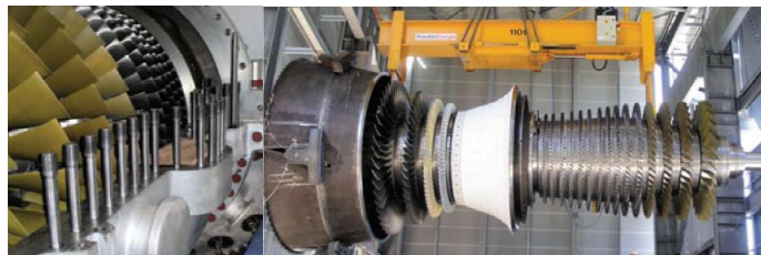
Turbina a gas ciclo combinato RPW 2°GT
