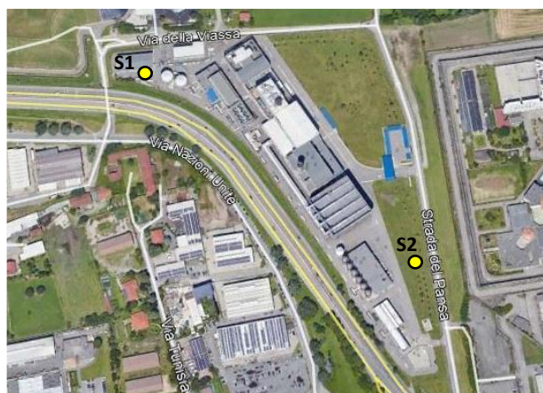
Disposizione planimetrica dei piezometri S1 e S2
