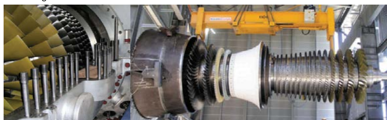
Turbina a gas ciclo combinato
