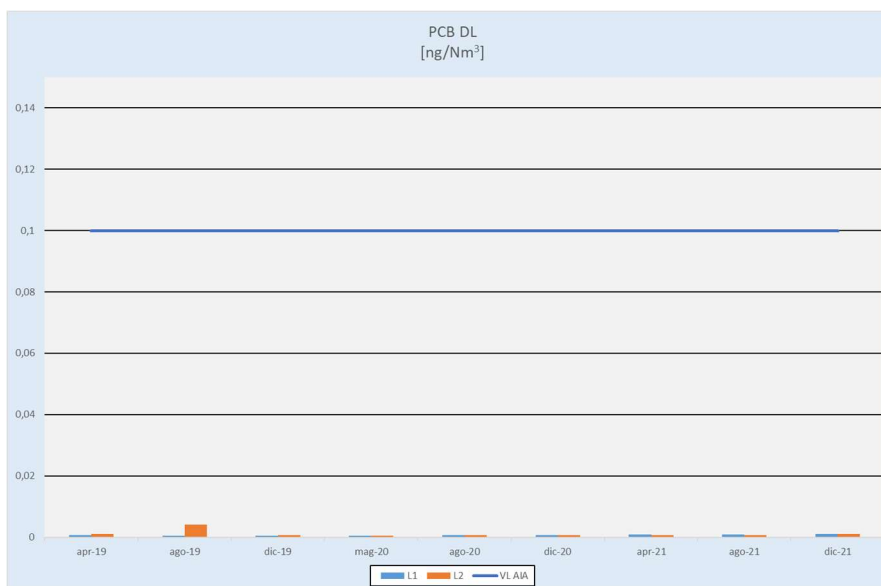
Grafico. n. 18 PCB DL: valori rilevati nei campionamenti discontinui sulle emissioni E25 ed E26 anni [2019-2021].
