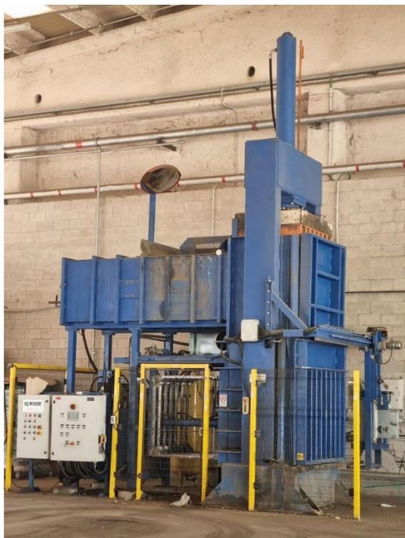
*Figura 9 – Pressa compattatrice per materiali isolanti*
