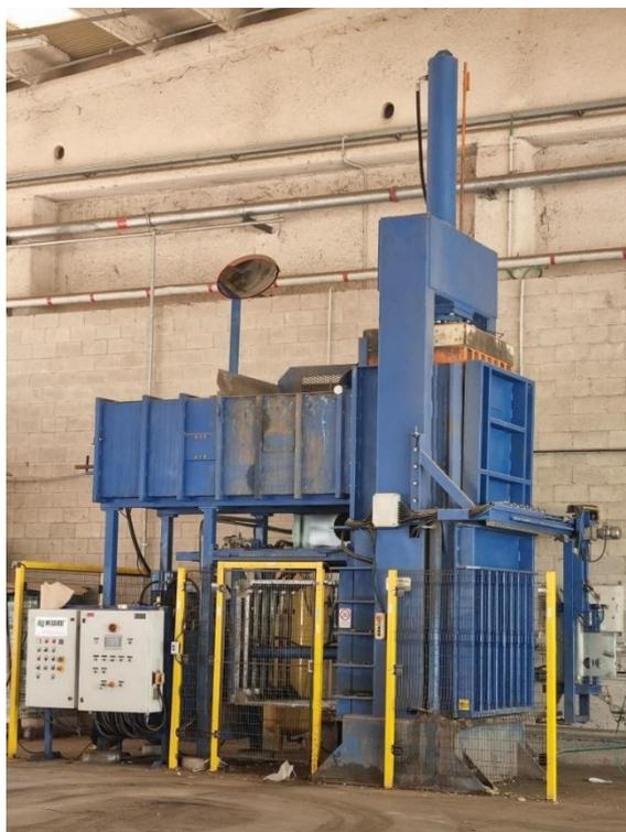
*Figura 10 – Pressa compattatrice per materiali isolanti*
