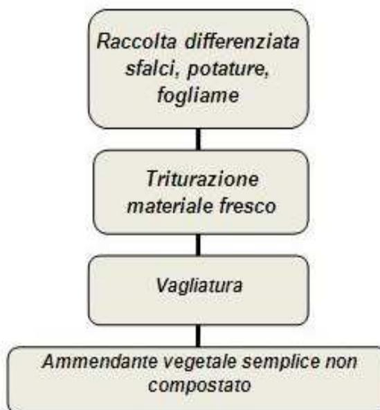
Il materiale verde conferito all'impianto, dopo essere stato tritato, viene sottoposto a vagliatura. Il sottovaglio viene sottoposto ad analisi al fine di verificare la rispondenza alle caratteristiche specifiche dell'All.2 punto 2.3. del D.lgs 75/2012 e s.m. risulta ammendante vegetale semplice non compostato.
