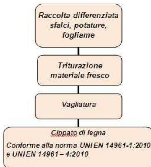
La UNI EN 14961- 4 definisce i principali parametri che dovrebbero essere presi in considerazione per stabilire la qualità del cippato, e per ciascuno di essi vengono specificati i valori tipici per le quattro classi di qualità (A1, A2, B1, B2).
